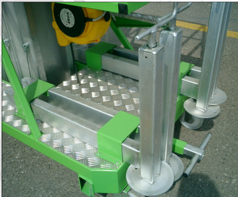
Stabilizzatori in acciaio con manovella e loro sede sul telaio
