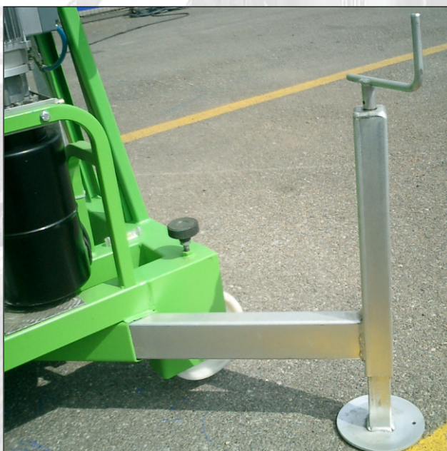
Stabilizzatori in acciaio con manovella e loro sede sul telaio
