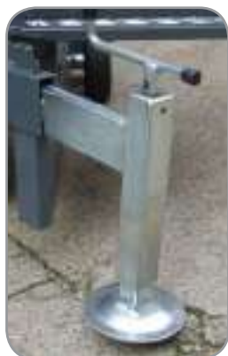
Estabilizadores extraíbles con husillos niveladores
