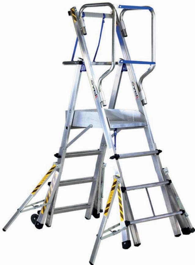
**TELEFLY LIGHT S** es una escalera telescópica móvil de almacén, fabricada en aluminio y equipada con plataforma amplia antideslizante y guardacuerpos perimetral para máxima seguridad. Incluye bandeja portaherramientas de 15 kg, estabilizadores antivuelco, y ruedas para fácil transporte. Sus barandillas plegables facilitan el almacenamiento compacto. Homologada según la norma EN131.7.
