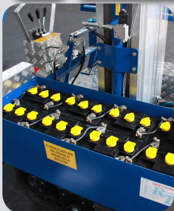
Compartimento de baterías
