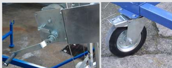
La manivela para elevar y hacer descender la plataforma de trabajo, se encuentra en el bastidor
