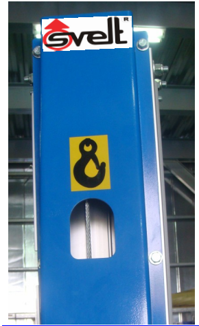
Cavo sotto il basamento in acciaio e punto di sollevamento della gru per un trasporto sicuro
