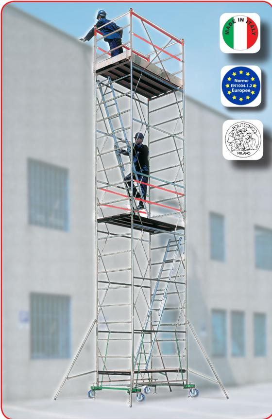
Il trabattello Professional è realizzato in acciaio FE360 zincato elettroliticamente contro la ruggine. Offre grandissima sicurezza di lavoro e facilità di montaggio. Le crociere formano una struttura staticamente perfetta che non può subire torsioni anche a grandi altezze, fornendo inoltre un ampio spazio di lavoro in facciata. Ruote certificate con freno a pedale.
